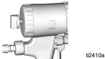
13. Realice una pulverización de prueba sobre un cartón. Ajuste el regulador de aire para obtener la presión de fluido mínima que permita un patrón de pulverización adecuado.
