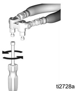
3. Acople el colector de fluido de la pistola. Conecte la tubería de aire de la pistola. Abra la válvula de la tubería de aire.
